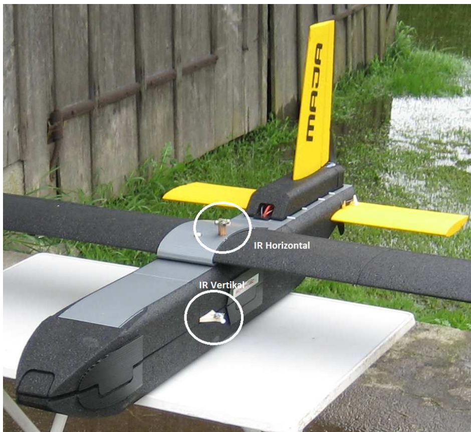
Abb. 4 Platzierung und Montage der IR-Sensoren an der MAJA
