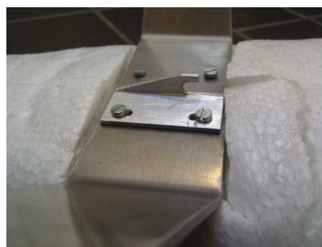
Abbildung 7.6.: Position des Bungeehakens (Ansicht von unten)
