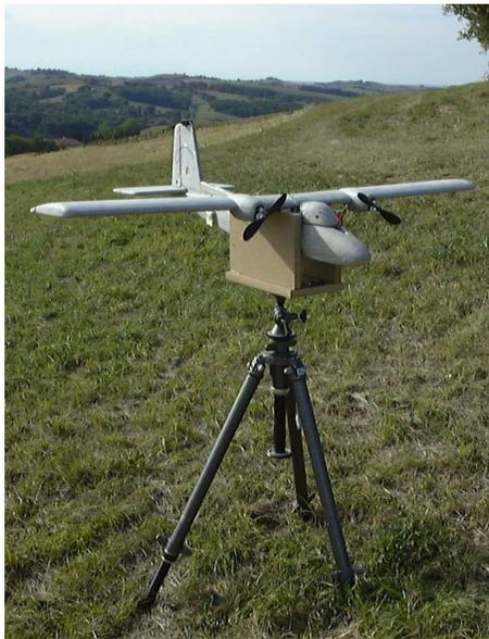
FIG. 1.3 – Le drone Twinstar du projet Paparazzi
